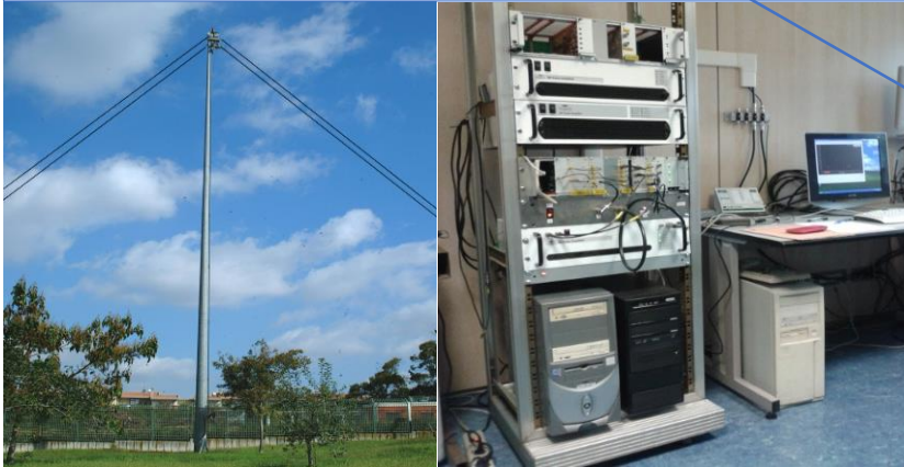
Antennas (Tx and Rx) AIS-INGV ionosonde
